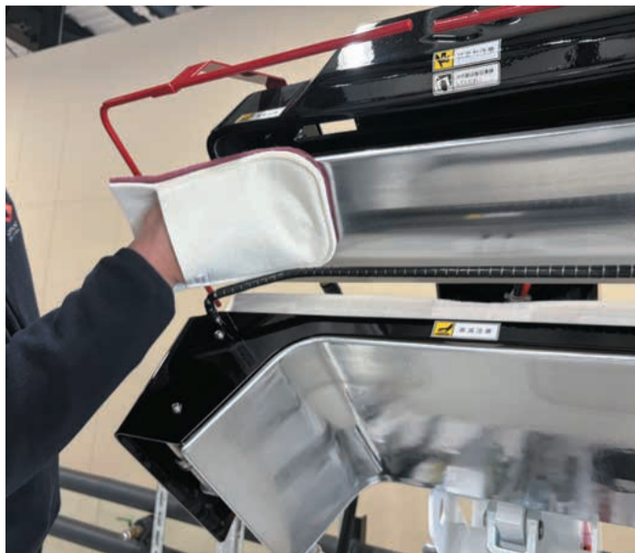
▲磨き面(赤色)には3Mの「スコッチ・ブライト工業用パッド」を使用
