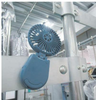
▲強力マグネット内蔵で様々な場所に設置できる。風向きは前後180度自由に調整可能
