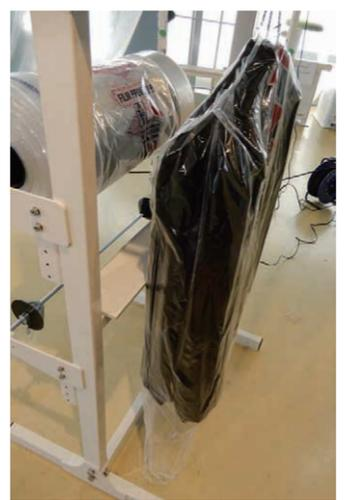
760シリーズ」なら、集合包装用の700mm幅と、個別包装用の600mm幅の同時セットが可能。このように集合包装を行う際も、工場の規模に応じて、選択肢が広がってきた。
