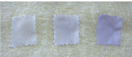
▲3分間の洗浄テスト結果。下は白布で左からAMGゆかた用洗剤、他社製品、水のみ
